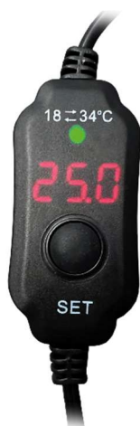
Fig. 1: Contrôleur avec affichage de la température et bouton de réglage de la valeur de consigne
