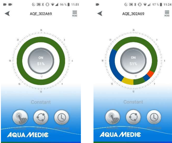
Fig. 19: Pour activer un programme qui a été créé, il faut appuyer brièvement sur le bouton PROGRAM. L'affichage passe alors au programme créé.
