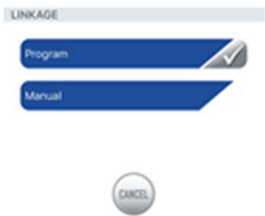
Fig. 21: Een programma mode of een handmatige mode kan ingesteld worden voor de "MASTER" pomp. De instelling kan gedaan worden zoals beschreven onder handmatige mode of Timer mode.
