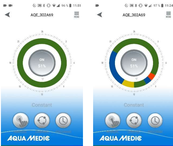
Fig. 19: Om een aangemaakt programma te activeren, moet de PROGRAM-toets kort worden aangeraakt. Het display verandert dan in het aangemaakte programma.
