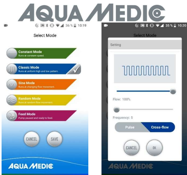
Fig. 26 : ... appuyez sur le symbole de la vague devant « Classic Mode » et sélectionnez « Crossflow » (mis en évidence en bleu). Le débit de la pompe varie sous «Flow», le temps de mise en marche et d'arrêt avec «Frequency» (minimum 30 secondes env., maximum 90 minutes env.). Enregistrez avec «OK» et «SAVE». Les pompes peuvent prendre jusqu'à trois cycles pour «trouver» leur rythme alterné. Vous devez donc commencer par un cycle au niveau le plus bas et l'augmenter si les pompes changent uniformément.
