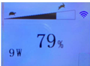
Fig. 2 : Affichage du contrôleur de pompe
