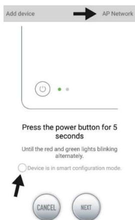
Fig. 4 : En touchant le cercle au-dessus de la flèche inférieure, le mode souhaité est confirmé. En appuyant sur «Réseau AP» ou «Réseau intelligent» à côté de la flèche supérieure (la flèche n'est pas disponible dans l'APP), vous pouvez basculer entre les deux modes. (Le « Mode de configuration intelligente » doit être sélectionné ici. Les LED verte et rouge clignotent uniquement sur les pompes doseuses; dans le cas des pompes, le symbole WiFi bleu clignote dans le contrôleur).
